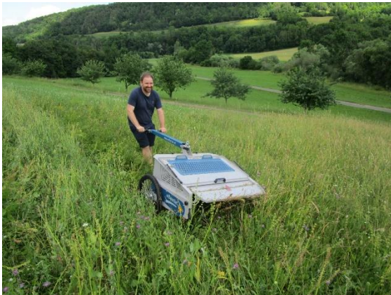
Foto 13: Der E-Beetle, eine mit Akku betriebene "Kehrmaschine", welche die Samen aus der Wiese "bürstet".
