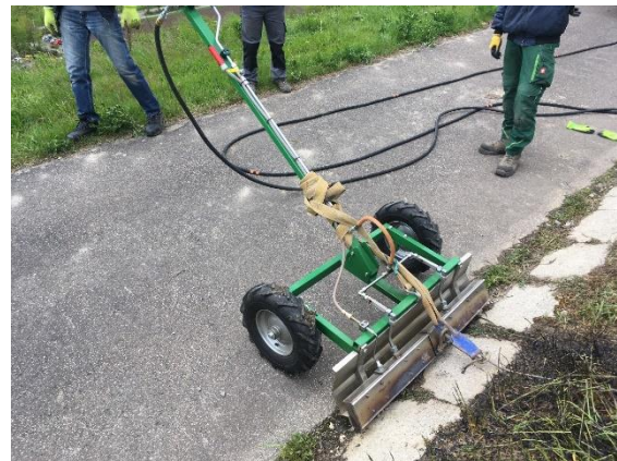
Foto 7: Pyrolysegerät der Marke Eigenbau. Die Versorgung mit Flüssiggas wird über einen Schlauch am Gerät gewährleistet.
